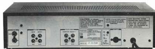
Il retro del registratore Aurex PC-X 88. Le prese consentono di utilizzare il sistema ADRES anche con una seconda piastra.
